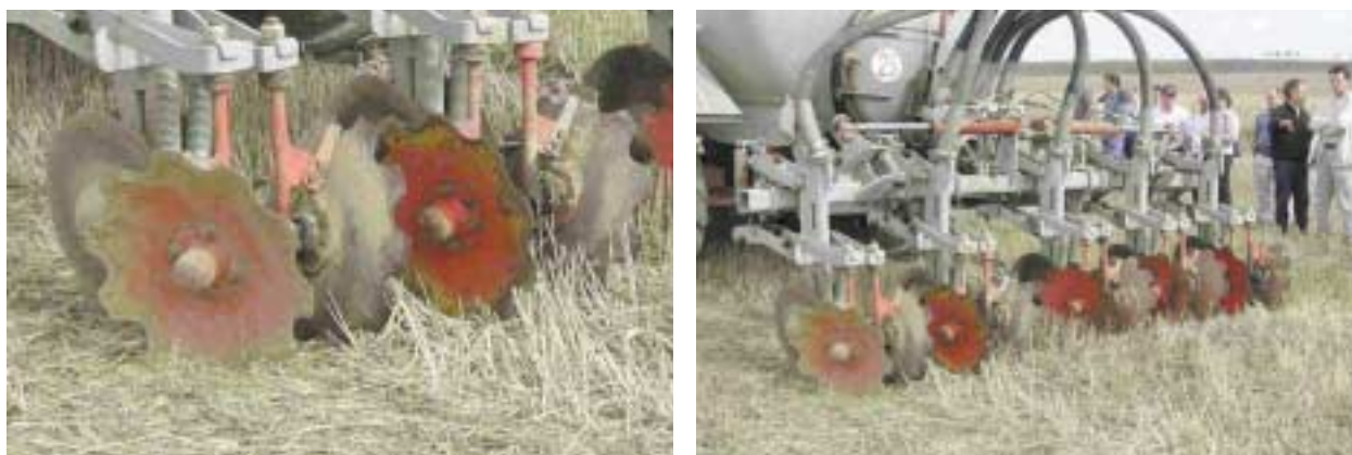
Figura 5. Aplicación de purín mediante enterrador con disco
