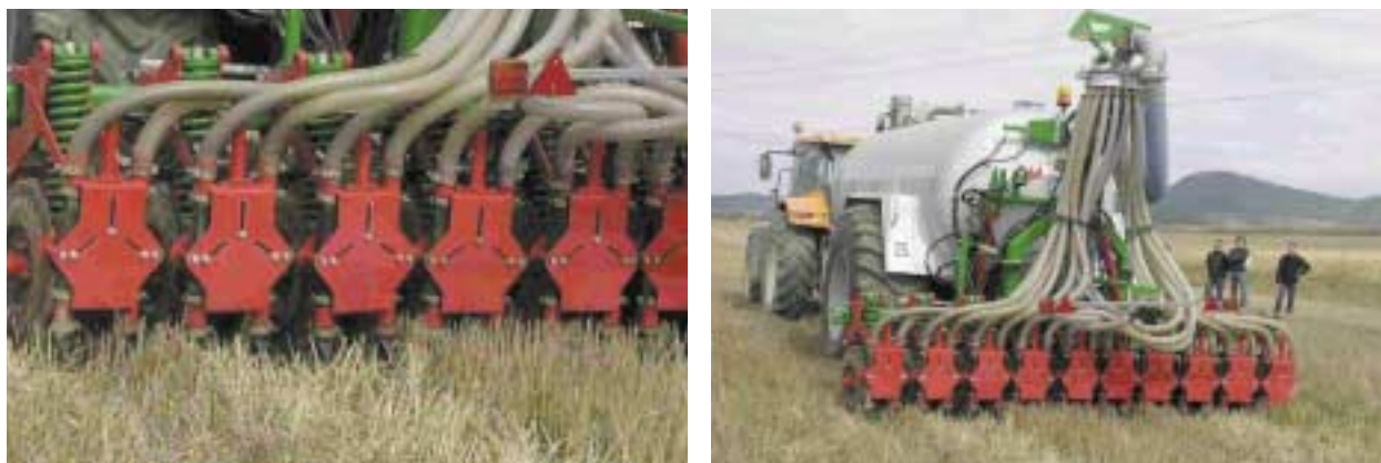
Figura 6. Aplicación de purín mediante inyección
