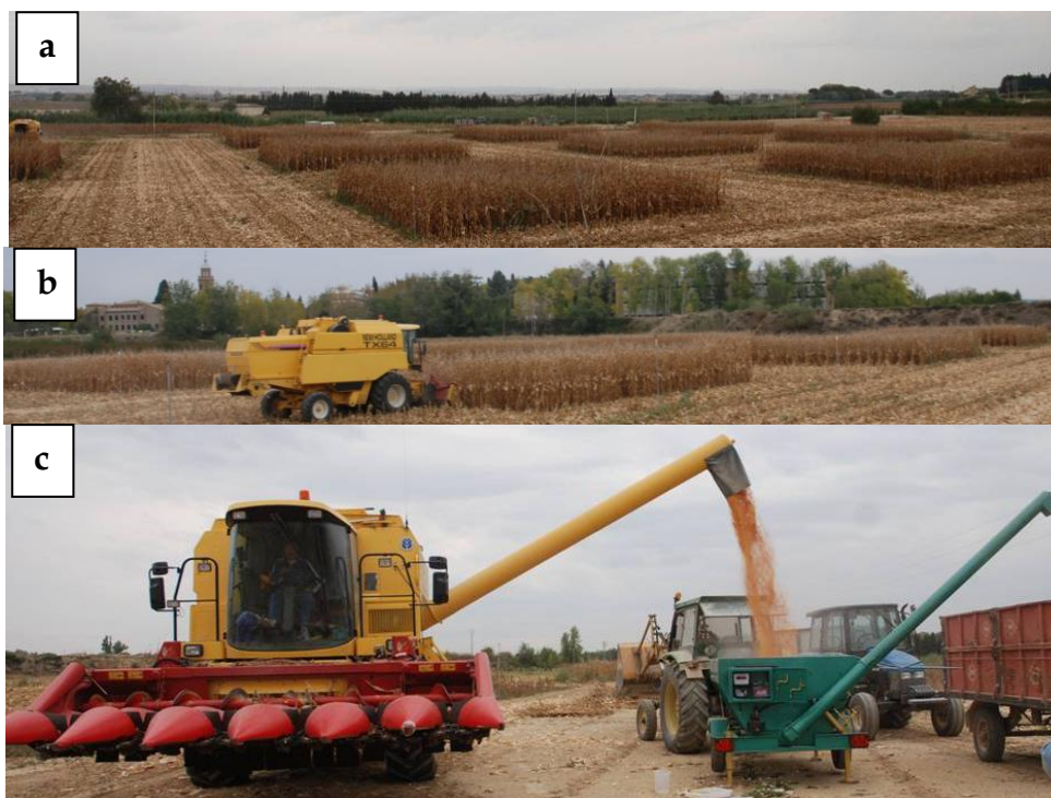
Figura 3. Fotos del proceso de cosecha mecánica del maíz: Vista general de la cosecha (3a), cosechando una subparcela experimental (3b) y pesando el grano cosechado de cada subparcela en un remolque pesador (3c).
