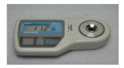
Imagen 5: Refractómetro digital PR-101ATAGO CO.
