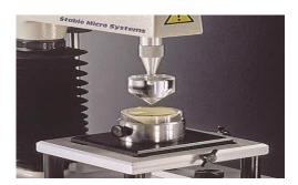
Imagen 4: Medición de la untabilidad en queso con la sonda cónica.
