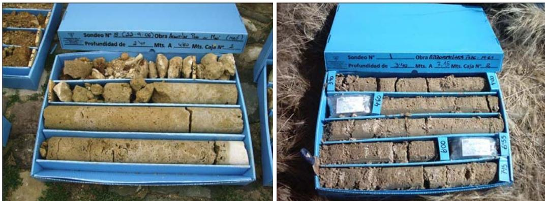
**Figura X.** Ejemplo de testigos recuperados durante la perforación de un sondeo a rotación con testigo continuo.
