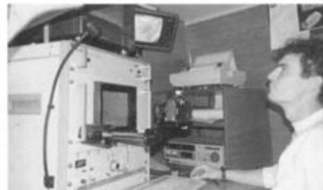
Fig. 10.8. Unidad de control y manejo de un equipo de inspección de sondeos con televisión (foto J. Martínez).
