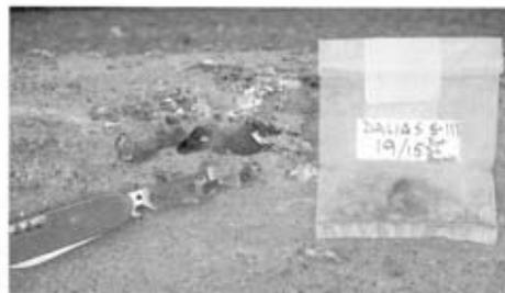
Fig. 10.25. Toma de muestras de incrustaciones de tubería de impulsión del grupo de bombeo instalado en el sondeo (foto J. Martínez).
