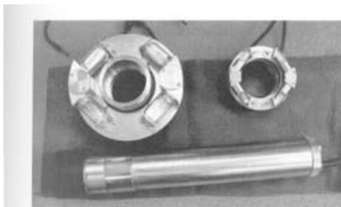
Fig. 10.7. Cámara de televisión con capacidad de trabajo de hasta 100 bar (1000 m de columna de agua) de IBAK (foto J. Martínez).
