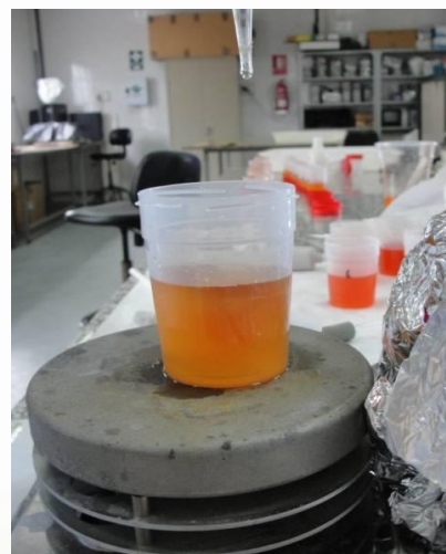
Imagen 6: detalle de la valoración ácido-base de la acidez
