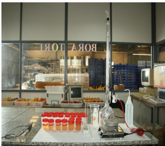
Imagen 5: titrador semi automatico para valoración de acidez
