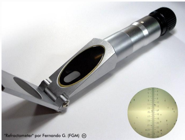
Imagen 3: Refractómetro manual. Este modelo es portátil y de bajo coste. Detalle de la medida en la interfase clara y oscura que se forma
