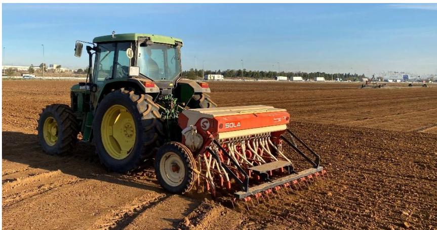
**Figura 3.** Sembradora “Solá” empleada para la siembra de camelina en la Finca El Encín.
